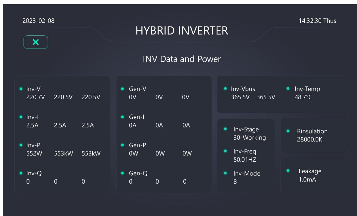
Figura 3.8 Diagrama esquemático dos dados de operação do inversor
